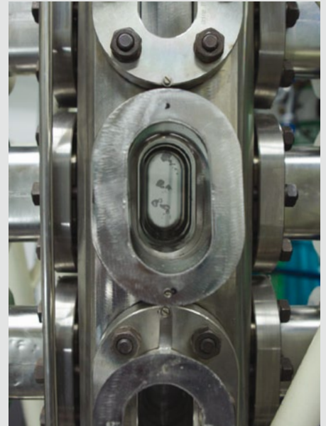
Während Gasblasen in einer Flüssigkeit aufsteigen, entstehen an ihren Grenzschichten neue Produkte.
